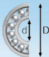
Отверстие: d Наружный диаметр: D Размеры в мм
