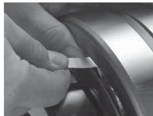
Рис. 14. Измерение РВЗ в домонтажном состоянии.
