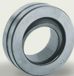
Радиально-упорные шарнирные подшипники (Ø 25 - Ø 200 мм) для особо высоких радиальных и осевых нагрузок, в том числе с системами смазочных канавок для масла и консистентной смазки
