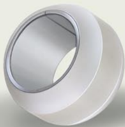
Специальные детали, состоящие из втулки Permaglide® и навулканизированной на неё пластической массы. В данном случае – шарнирный элемент для компенсации угловых перекосов. Изготавливается из всех стандартных материалов
