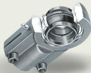
Гидравлические шарнирные головки представляют собой комбинацию радиальных шарнирных подшипников и шарнирных головок с креплением винтами, при помощи фланца или сваркой
