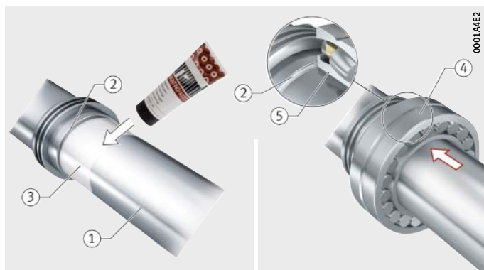
Рисунок 14 Нанести монтажную пасту, установить подшипник
