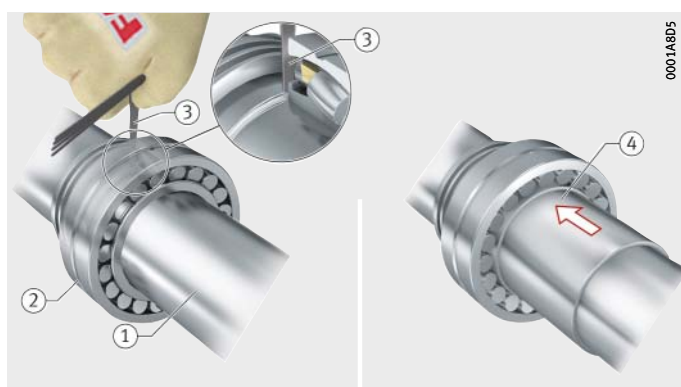
Рисунок 15 Проконтролировать прилегание внутреннего кольца подшипника к заплечу вала, установить дистанционную втулку (если вал проходит сквозь корпус)
